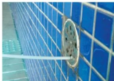
Figura 7 – Medição da variação da pressão na entrada de cada ponto de captação, em que foi verificado poeira, evidenciado sucção de ar
