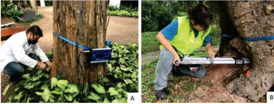
Figura 2 – Equipamentos de análise interna de árvores: tomógrafo de impulso (A) e penetrógrafo (B)
